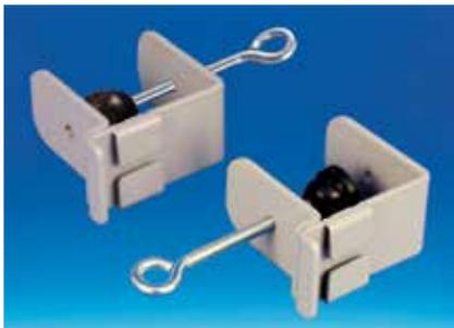
Porte-fronton serre-joint se fixant sur tous types de tablettes de 3 à 30 mm. Permet de recevoir des clips porte-fronton de 3 et 5 mm droit ou incliné (non livré). Possibilité de positionner la vis de serrage en bas ou en haut de la pièce (pour la dissimuler derrière le panneau). Hauteur maxi. conseillée du panneau : 400 mm.
